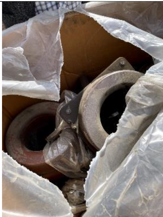
Фото 34 Трансформатор тока шинный на напр. 10 кв (ТЛШ10-4000) (2)
