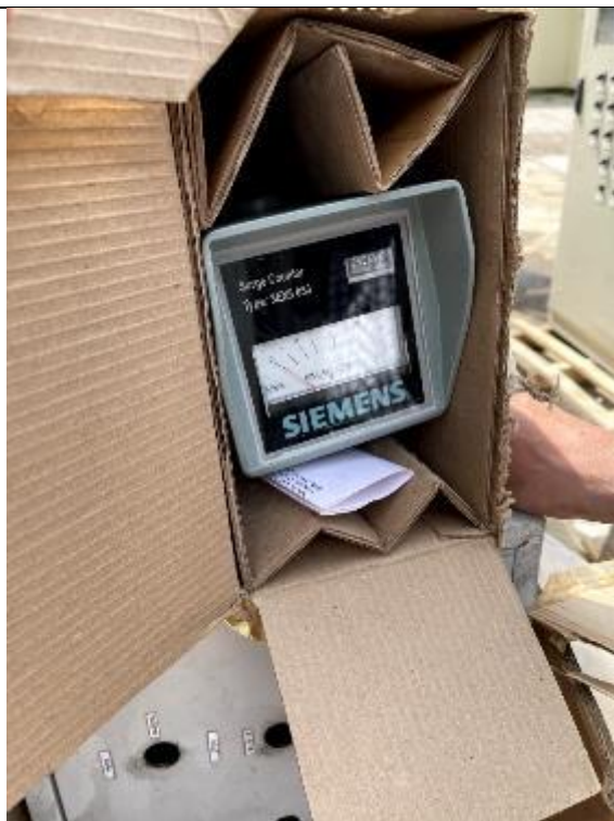
Фото 29 Счётчик числа срабатываний ОПН (3EX 5050)
