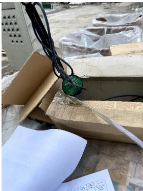
Фото 7 Ограничитель напряжения 220в (LVA- 280B-D-L) (1)
