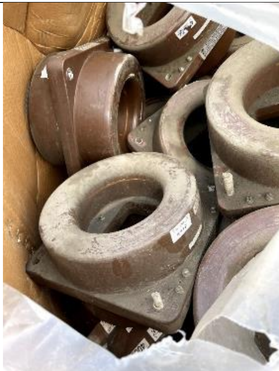
Фото 33 Трансформатор тока шинный на напр. 10 кв (ТЛШ10-4000) (1)
