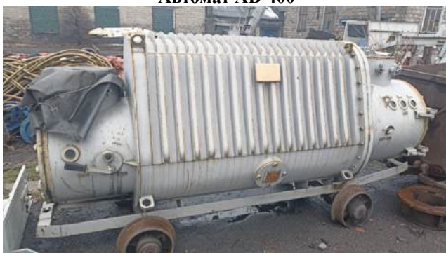
Трансформаторная подстанция КТПВ-630/6-1,2/0,69
