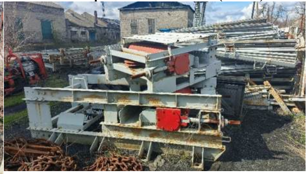
Конвейер ленточный ЛК-800 (L300м)
