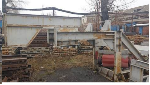
Конвейер ленточный ЛК-800 (L300м)
