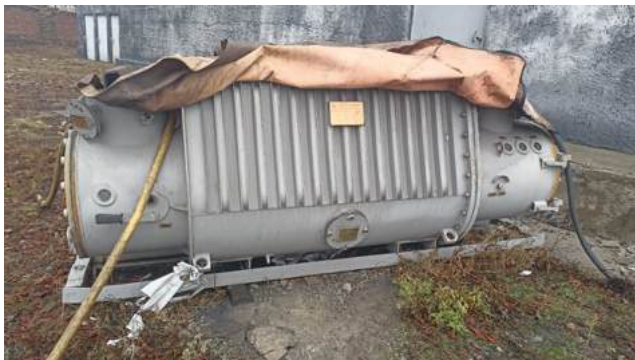
Трансформаторная подстанция КТПВ-400/6/0,69-0,4 УХЛ5
