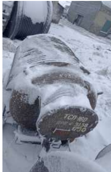
Трансформатор ТСП-160, инв. №000862
