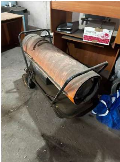
Дизельная тепловая пушка Danfoss BFP 21 L3 производство – Дания
